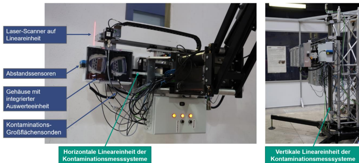
Abbildung 1: Aufbau des Kontaminationsarrays an einem Ausleger (l.) und auf mobiler Plattform (r.)
